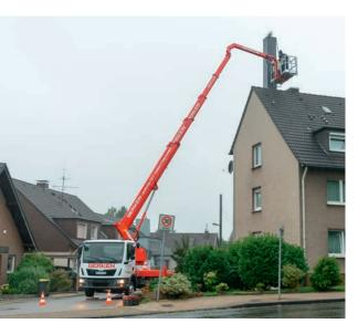
Die GL 29 G erreicht **28,63 Meter Arbeitshöhe** und verfügt über einen **5,17 Meter langen, unterzogenen Korbarm**. Diese Konstruktion ermöglicht es der GL 29 G, Einsatzorte hinter Störkanten, z. B. auf Dachflächen, zu erreichen, für die bislang größere Arbeitsbühnen mit höheren Mietpreisen erforderlich waren.
