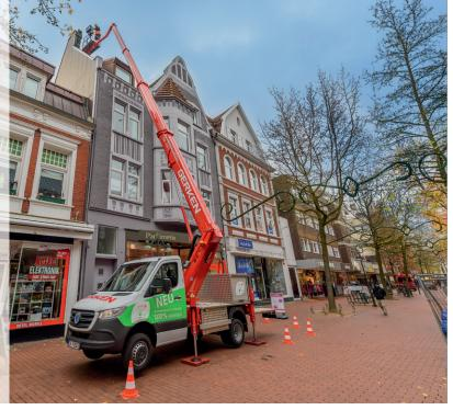
Die GL 25 N Elektro hat ein Einsatzgewicht von 5.000 kg und kann nahezu lautlos und emissionsfrei an sensiblen Orten eingesetzt werden.
