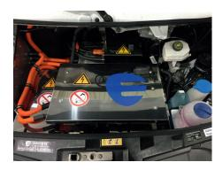
Statt Dieselmotor ist die GL 25 N Elektro mit einem leistungsfähigen Elektromotor und einem Lithium-Ionen-Akku ausgestattet, der den ganztägigen Einsatz ermöglicht.
